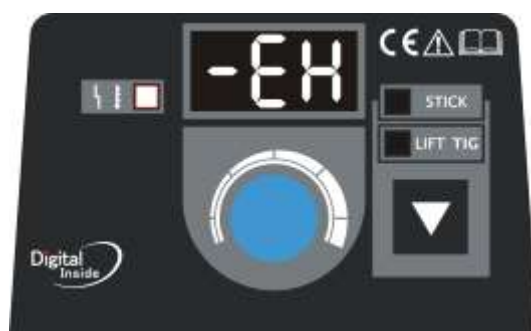
Рис. 4: Дисплей при перегреве
