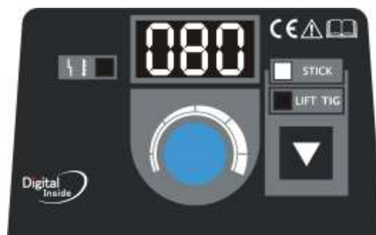
Рис 2: Интерфейс в режиме MMA
